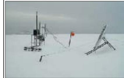
Con un peso de 400 Kg. y una altura de 2,5 mts. aproximadamente, fue armada de hierro y aluminio y provista de un sistema de aislamiento especialmente preparado en el Laboratorio de Física Nuclear. Este equipo se instaló a 2,5 km. del borde costero, en pleno glaciar y sobre un container enterrado a 5 mts. de profundidad
